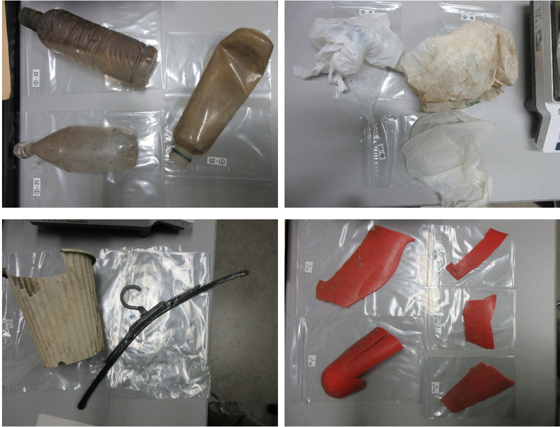
図1 手城川排水機場で採取したマクロプラスチックの乾燥試料の一例 (左上：ペットボトル、右上：レジ袋、左下：その他、右下：硬質プラスチック破片)
