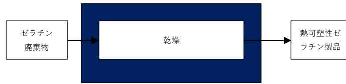
図 3-3-2 熱可塑ゼラチン製造のフロー
