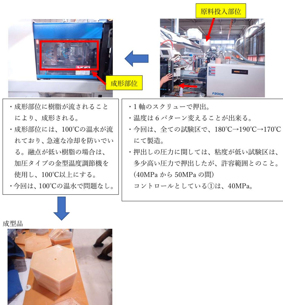
図 2-5-4 フジツボ養殖資材用金型を用いた射出成型工程の概略
