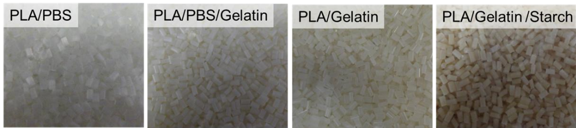
図 2-5-3 PLA および熱可塑ゼラチンと熱可塑デンプン配合 PLA 系材料のコンパウンド化により得られたペレット外観
