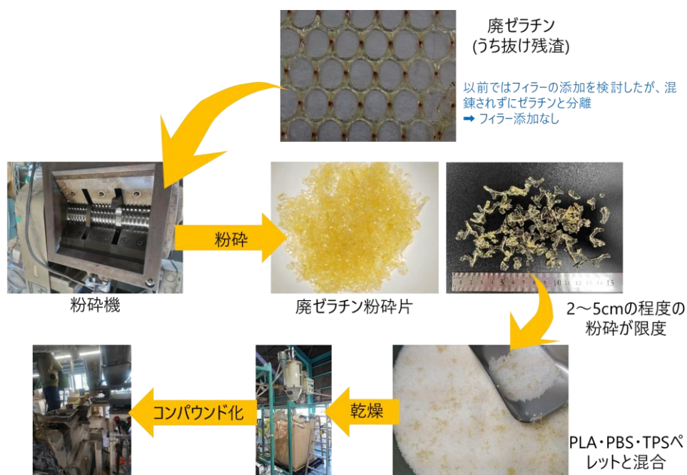
図 2-3-3 産業廃棄物由来ゼラチンを用いたペレット作製および乾燥工程の概略
