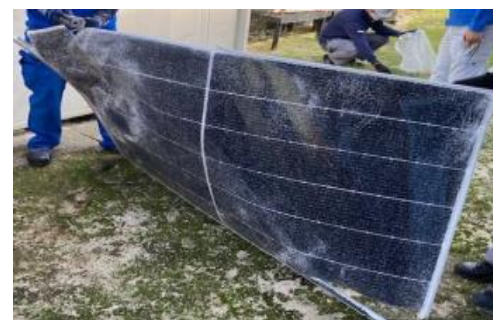
民家の庭に散乱したモジュール
