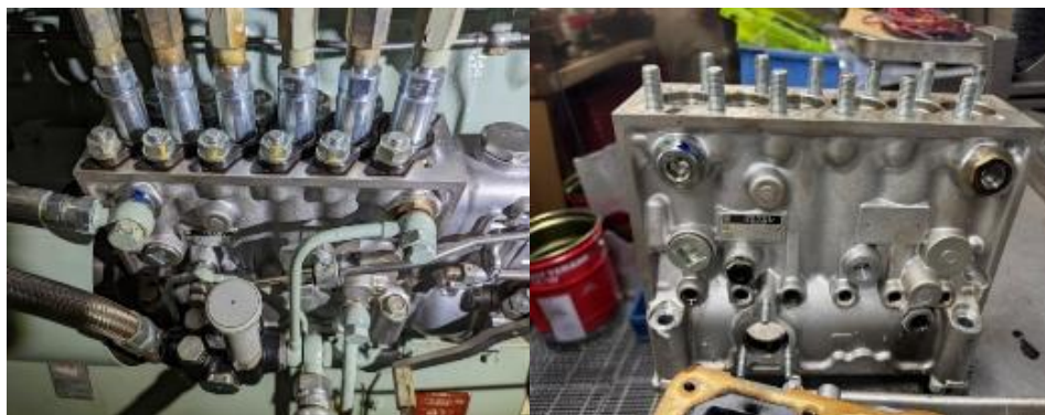
図 63：碇泊発電機関の燃料噴射ポンプとポンプブロック
