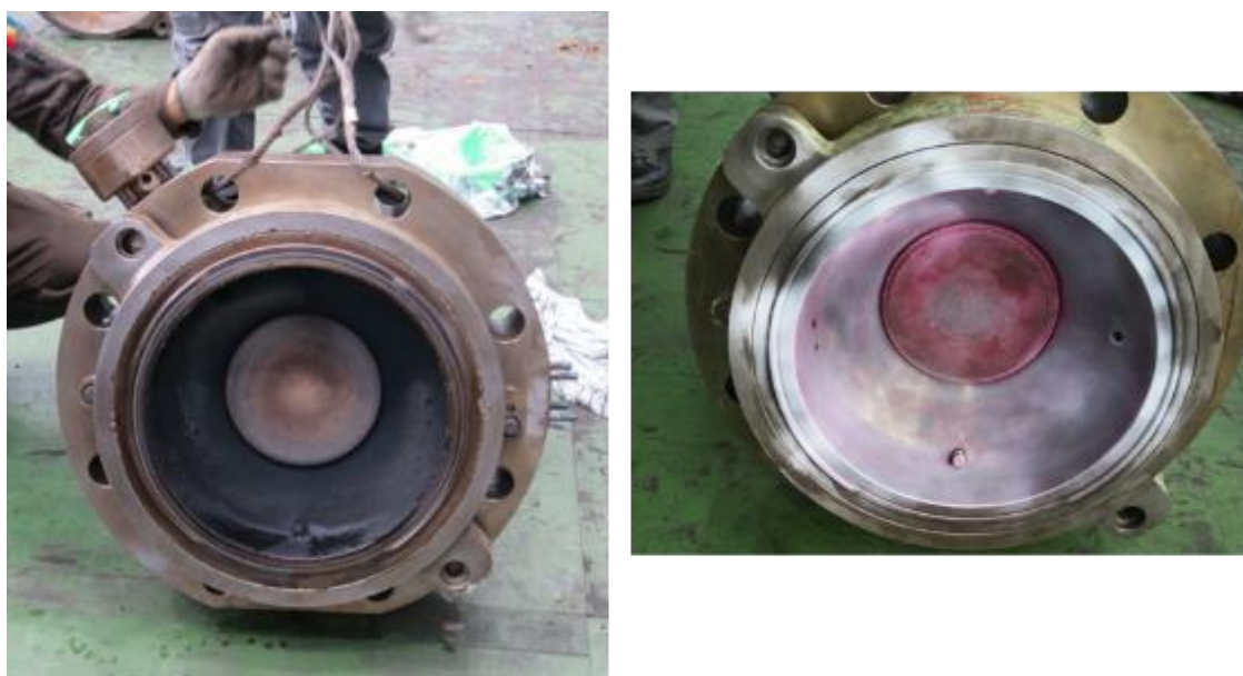
図 49：運航実証後の主機関のシリンダカバー
