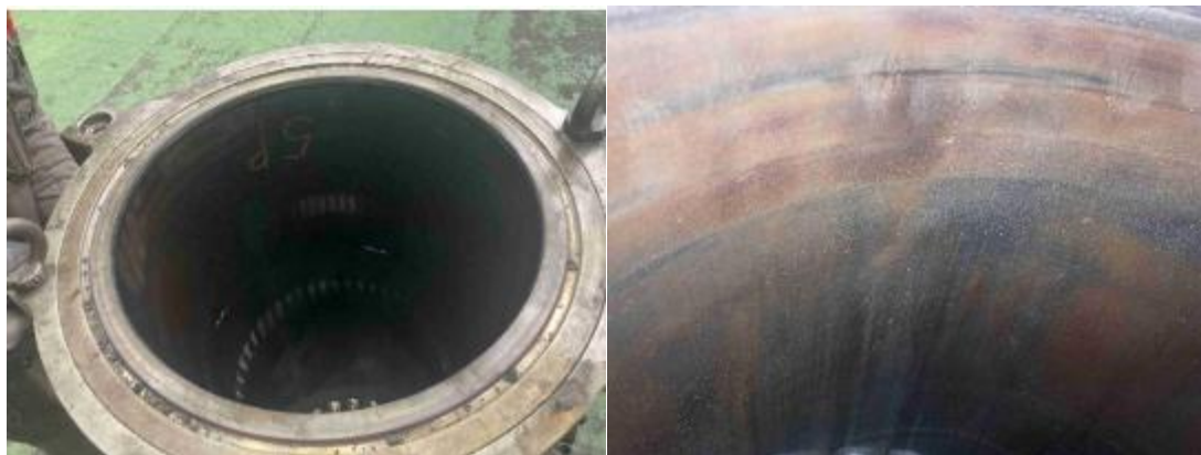
図 46：運航実証後の主機関のシリンダライナ
