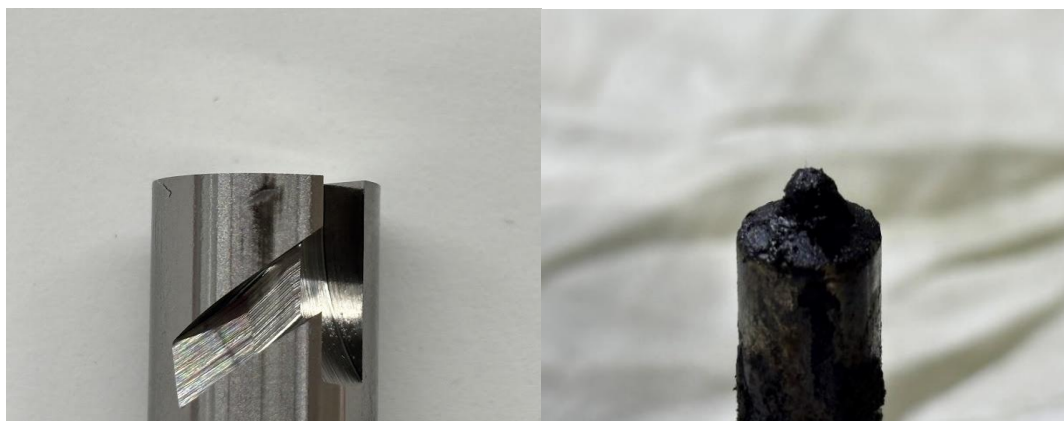
図 69：碇泊発電機関のプランジャー燃料流路部（左）および燃料噴射弁の噴射ノズル（右）
