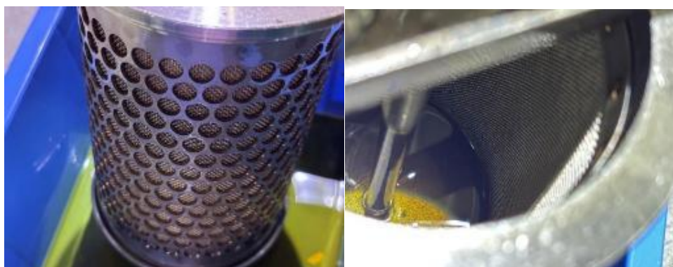
図 56：内部エレメントの状況
