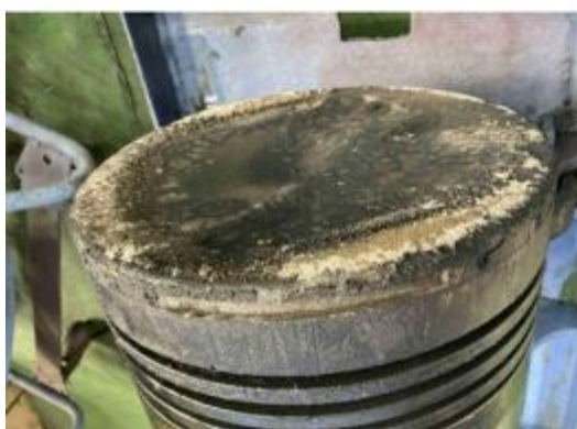
図 37：主機関のピストンクラウン
