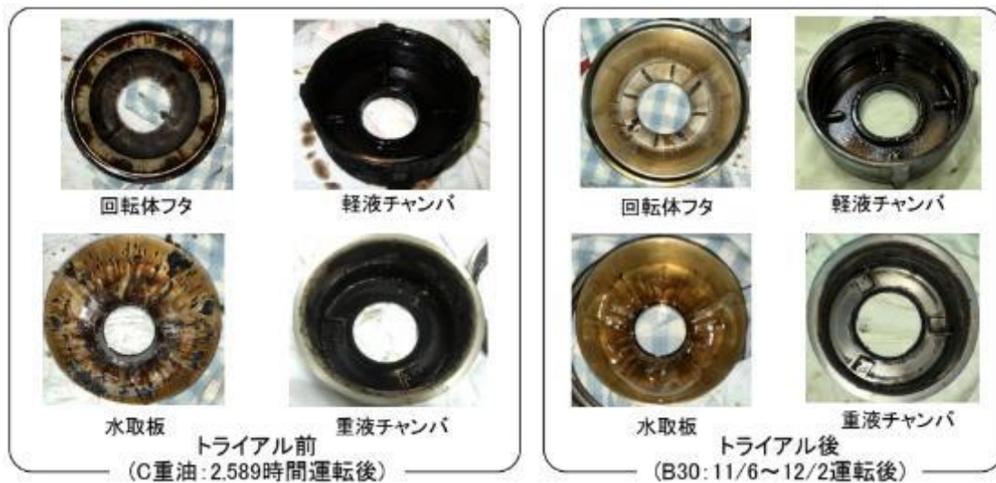
図 43：燃料清浄機における回転体内面の汚れ
