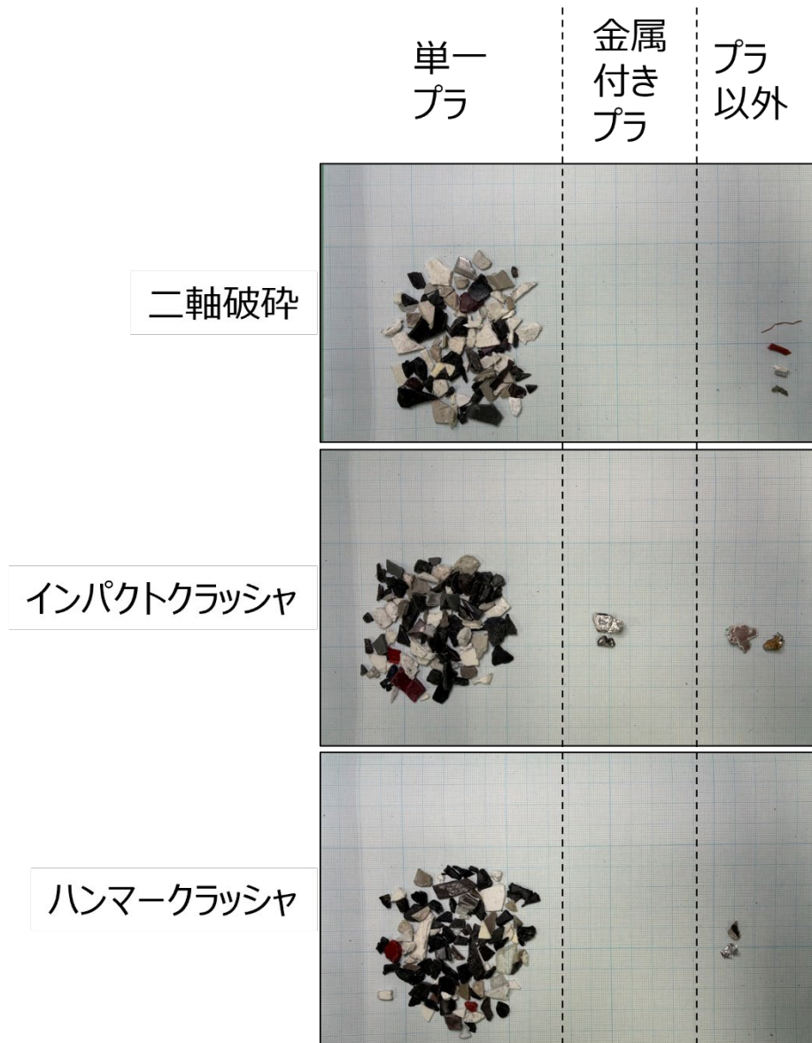
図 19 目視分類時の結果の例（サンプル：炊飯器）
