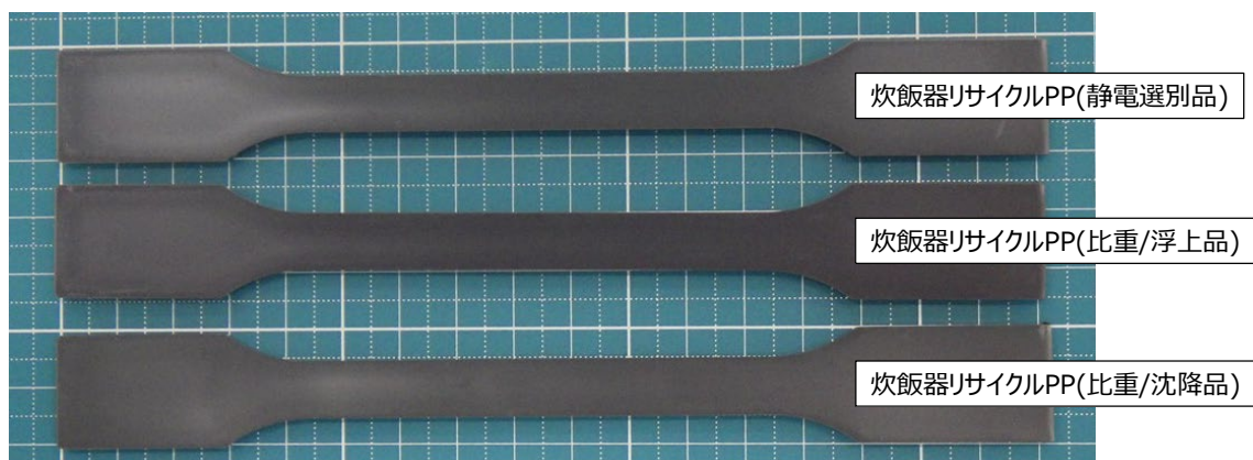
図 53 炊飯器由来リサイクル PP の ISO ダンベル試験片
