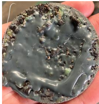
図 3.34. ベントアップ時のスクリーンメッシュの様子
