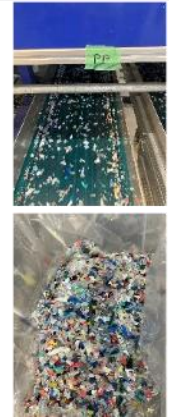
図 3.31. 光学選別プロセス
