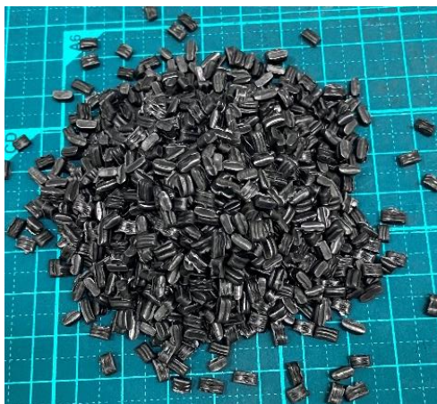
図 57 難燃性バージン LDPE の SWOM 後粉碎品に 24PS 2%添加したペレット
