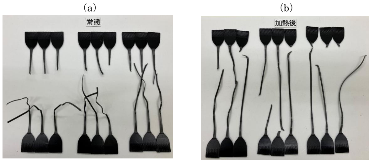
図 62 (a) 引張試験後サンプル (加熱なし) (b) 引張試験後サンプル (加熱後)
