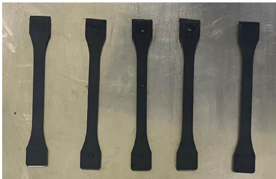
図 24 小型ダンベル試験片 (ISO527-2 1BA)
