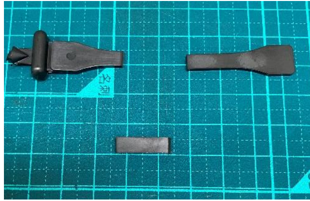
図 38 ダンベル試験片から切り取った測定試料
