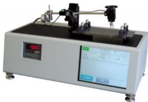
図 42 摩擦摩耗試験装置（トライボギア）
