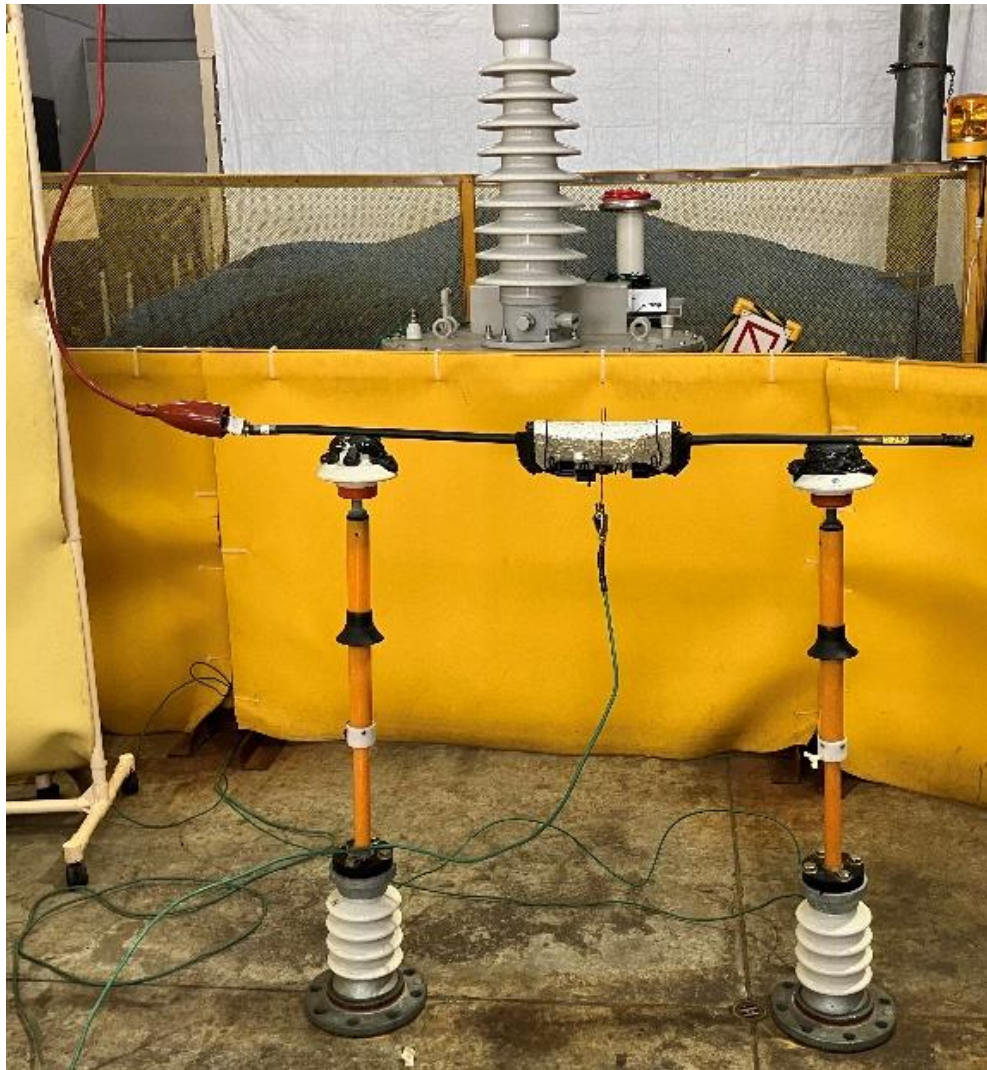
図 63 耐電圧試験設備にセット時の写真
