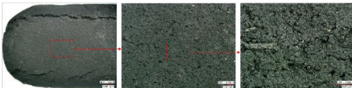
図(1)-52 CeF55%+リン系難燃剤 20%添加 PP の燃焼後サンプル表面顕微鏡画像
