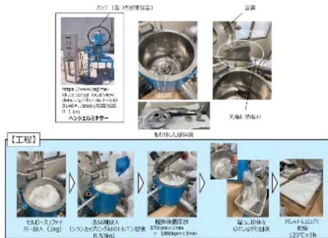
図(1)-8 ヘンシェルミキサーを使用したセルロースファイバーのシランカップリング剤処理工程
