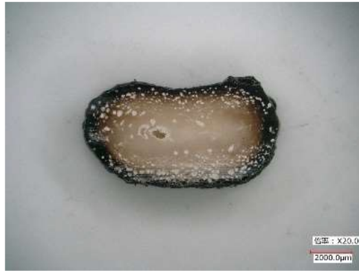
図(1)-47 CeF55%添加 PP の燃焼後サンプル断面
