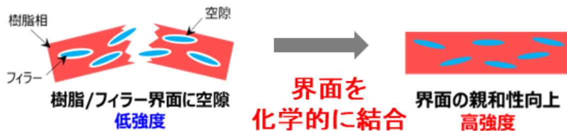
図(1)-2 樹脂～フィラー間の界面を化学的に結合させ、強度を向上させる
