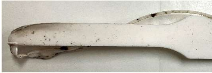
図(1)-42 リン系難燃剤 20%添加 PP の燃焼後サンプル表面
