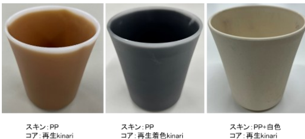
図(3)-12 リサイクルバイオマス材を用いたサンドイッチ成形品の外観写真
