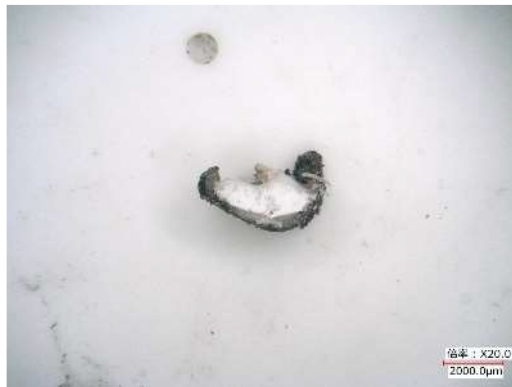
図(1)-43 リン系難燃剤 20%添加 PP の燃焼後サンプル断面
