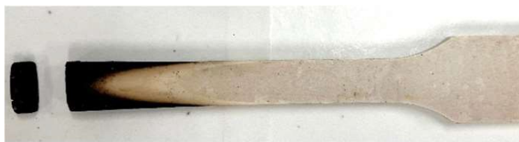
図(1)-50 CeF55%+リン系難燃剤 20%添加 PP の燃焼後サンプル表面
