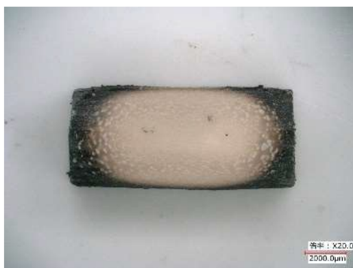
図(1)-51 CeF55%+リン系難燃剤 20%添加 PP の燃焼後サンプル断面
