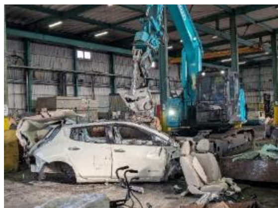
(B) 組合せ解体の様子（ニブラ解体）
