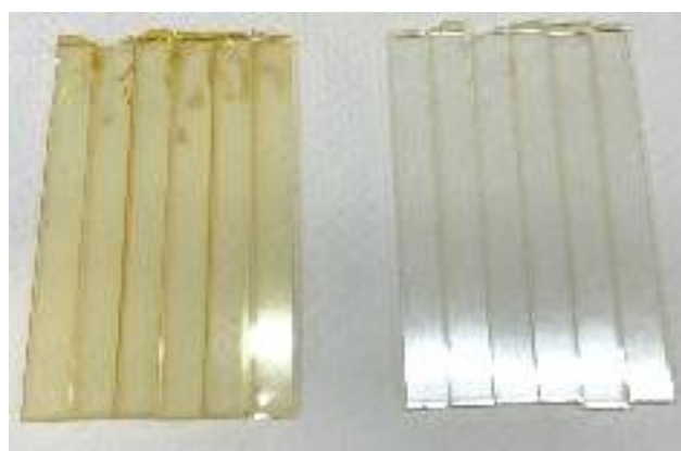
図 3-2-5 CFRP から回収したビスフェノール A を用いて再製造したエポキシ樹脂 (左) バージンのエポキシ樹脂 (右)
