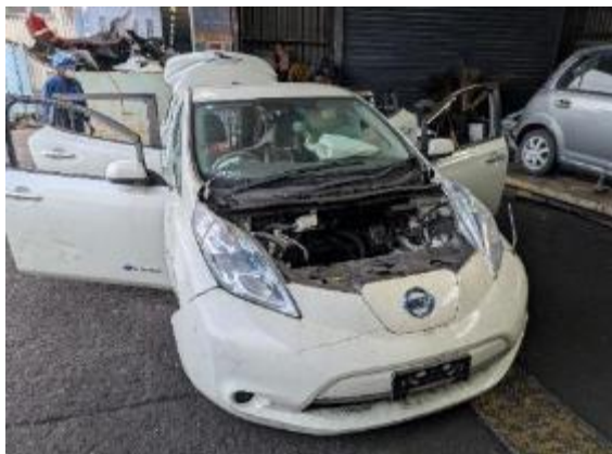
(A) 組合せ解体の様子（手解体）
