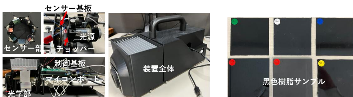
図 3-3-17 作成した波長固定方式の試作機
