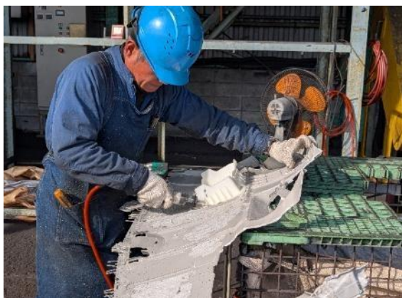
(C) 二次解体（吸音材の剥離）
