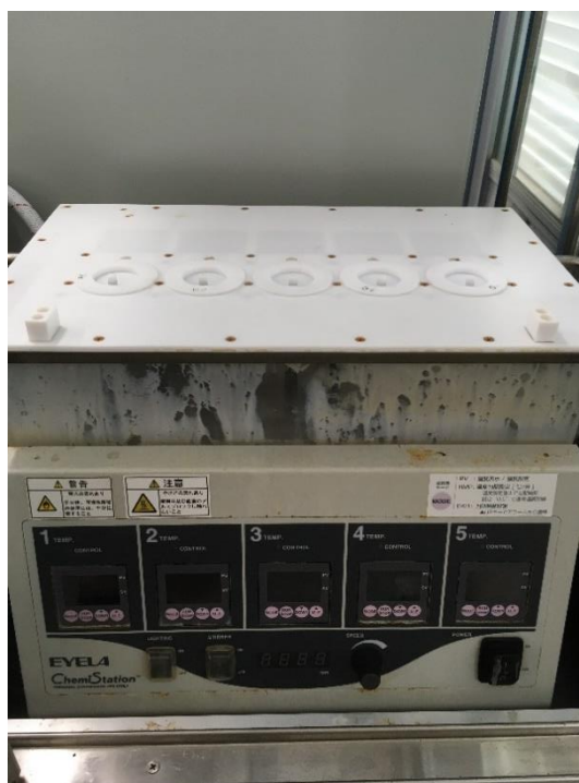
図3.23 重合に用いた東京理化学器械 (株) 製パーソナル有機合成装置; ケムステーション装置 (マグネチックスターラー付アルミブロック恒温槽)
