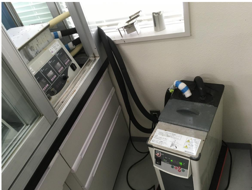
図3.24 重合装置の全体図；ケミステーションと低温・恒温水循環装置（チラー）
