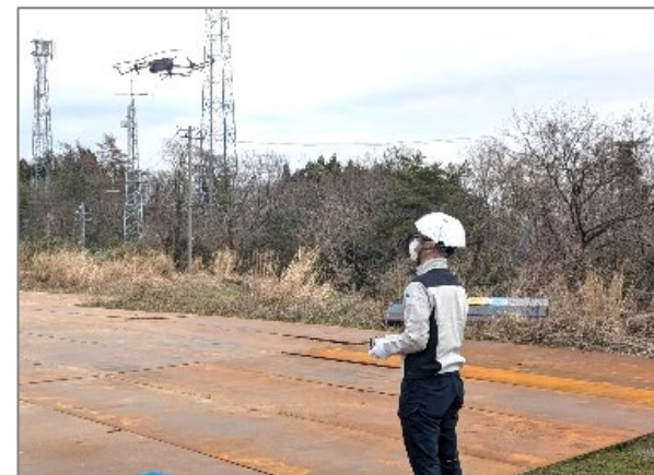
ドローンを用いた災害廃棄物搬入量の把握（輪島市）
