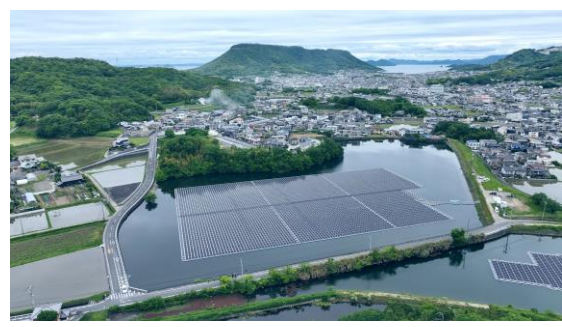
水鳥の飛来空間を確保した農業用ため池における水上設置型太陽光発電 (香川県高松市)
