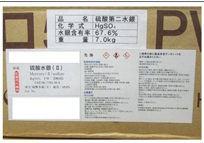
図 2.2.2 水銀化合物の貯蔵の表示例
