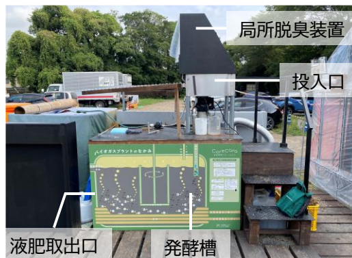
図 8 実証用小型バイオガスプラント(発酵槽の容量:300L)
