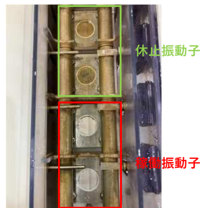
図 2-42 稼働振動子と休止振動子の汚れの差
