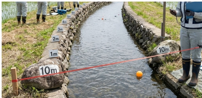
図 3-8 水路流速断面計測法の計測イメージ
