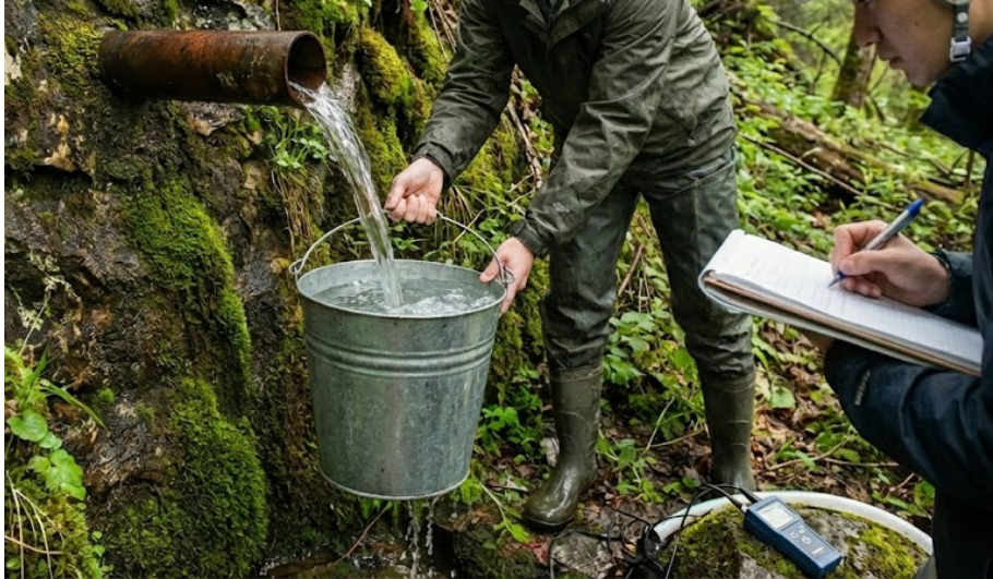
図 3-7 容器計量法の計測イメージ
