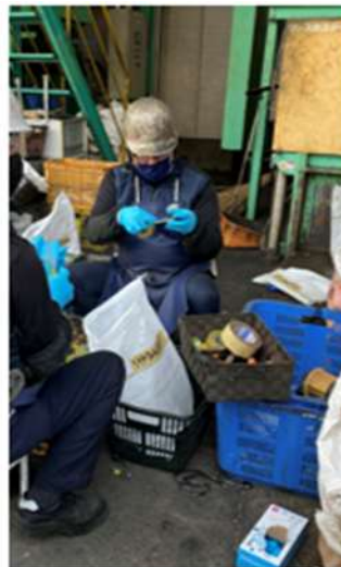
回収したリチウム蓄電池を絶縁処理している様子
