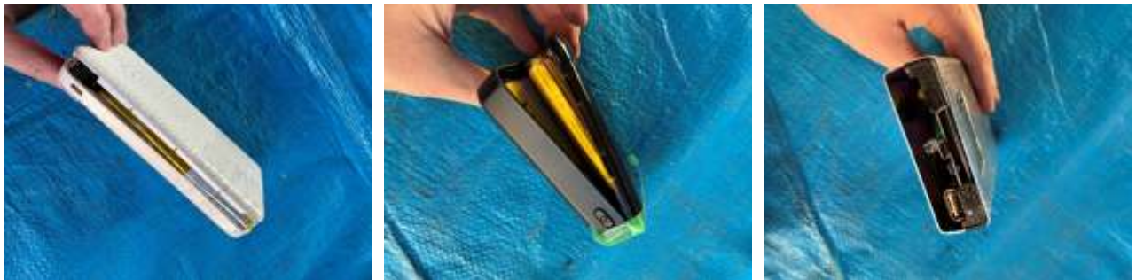
図 1-71 モバイルバッテリー(膨張・破損)_ローソン守谷松並庚塚店
