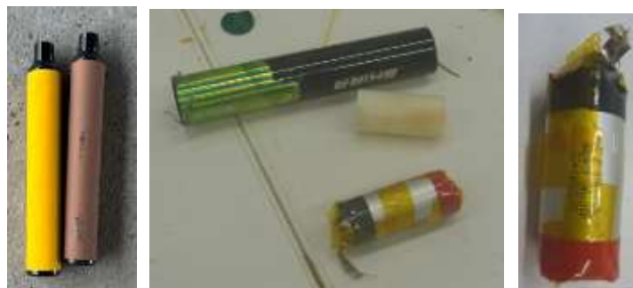
図 1-69 使い捨てシーシャとシーシャを分解したもの(中にリチウムイオン電池あり)_ ローソン守谷松並庚塚店
