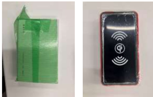
図 1-52 過剰な絶縁(本体全部または側面を全て覆っている)_ローソン神戸市役所西店
