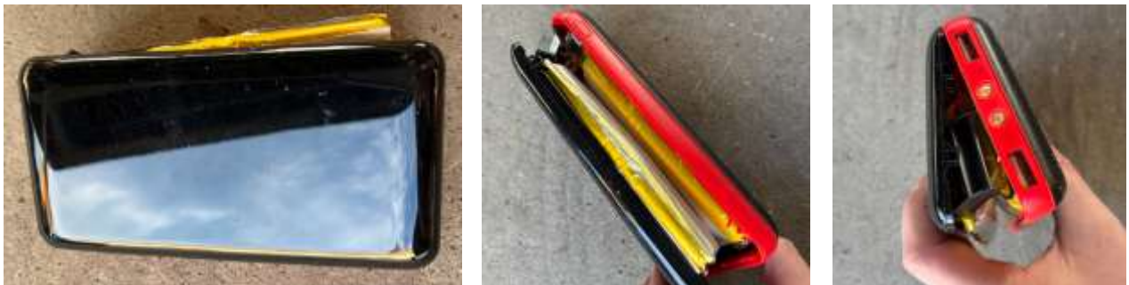
図 1-72 モバイルバッテリー(膨張・液漏れ) ※ビニール袋に入れて排出_ローソン守谷松並庚塚店
