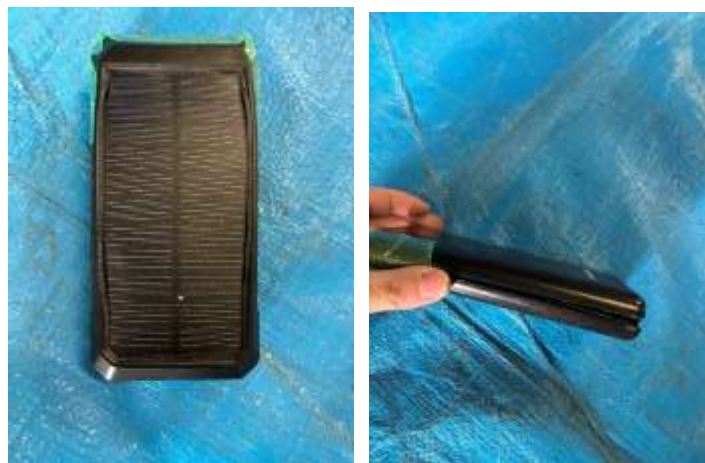
図 1-80 モバイルバッテリー(膨張・破損)_ローソン守谷大柏店
