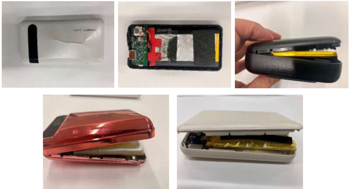
図 1-51 モバイルバッテリー(膨張・破損)_ローソン神戸市役所西店
