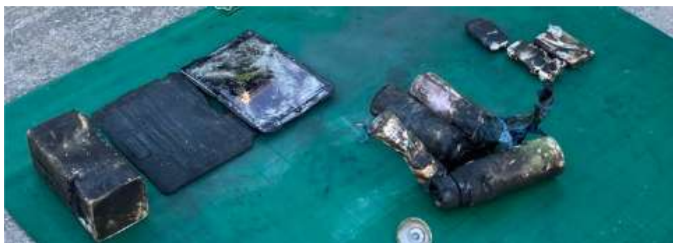
図 4-59 1月5日の火災の原因だと考えられるスプレー缶、リチウム蓄電池使用機器(埼玉県坂戸市)
