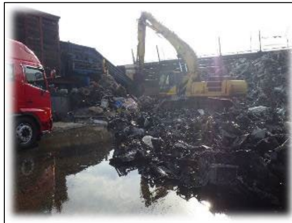
雑品スクラップの屋外保管に伴う油汚染
