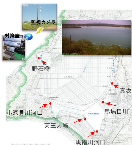
図 34 アオコ常時監視システム
