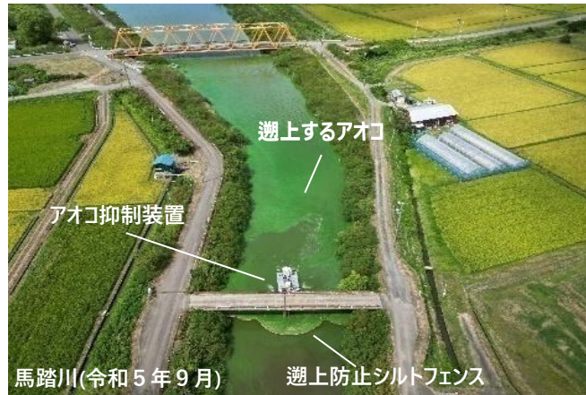
図 35 アオコ遡上防止フェンスと抑制装置
