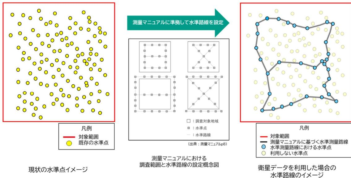
図 1-6 衛星データと水準測量を併用した測量作業の効率化のイメージ
