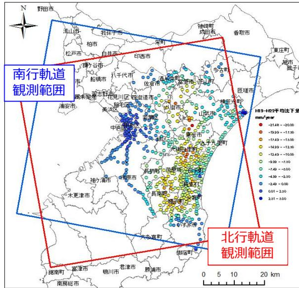
図 3-1 九十九里平野を対象とした ALOS での観測範囲と精度検証に用いた水準点の分布
