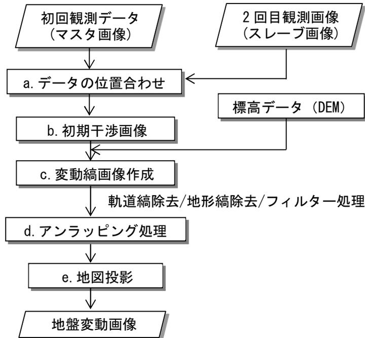
図 2-15 1 ペアの干渉 SAR 解析の流れ
