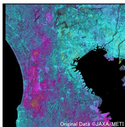
図 2-18 軌道縞・地形縞を除去した変動画像
