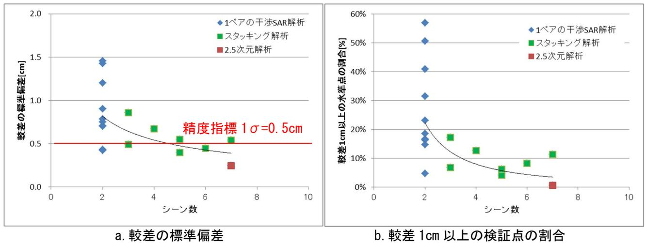
図 2-9 干渉 SAR 解析のシーン数と精度の関係（対象地：九十九里平野）
