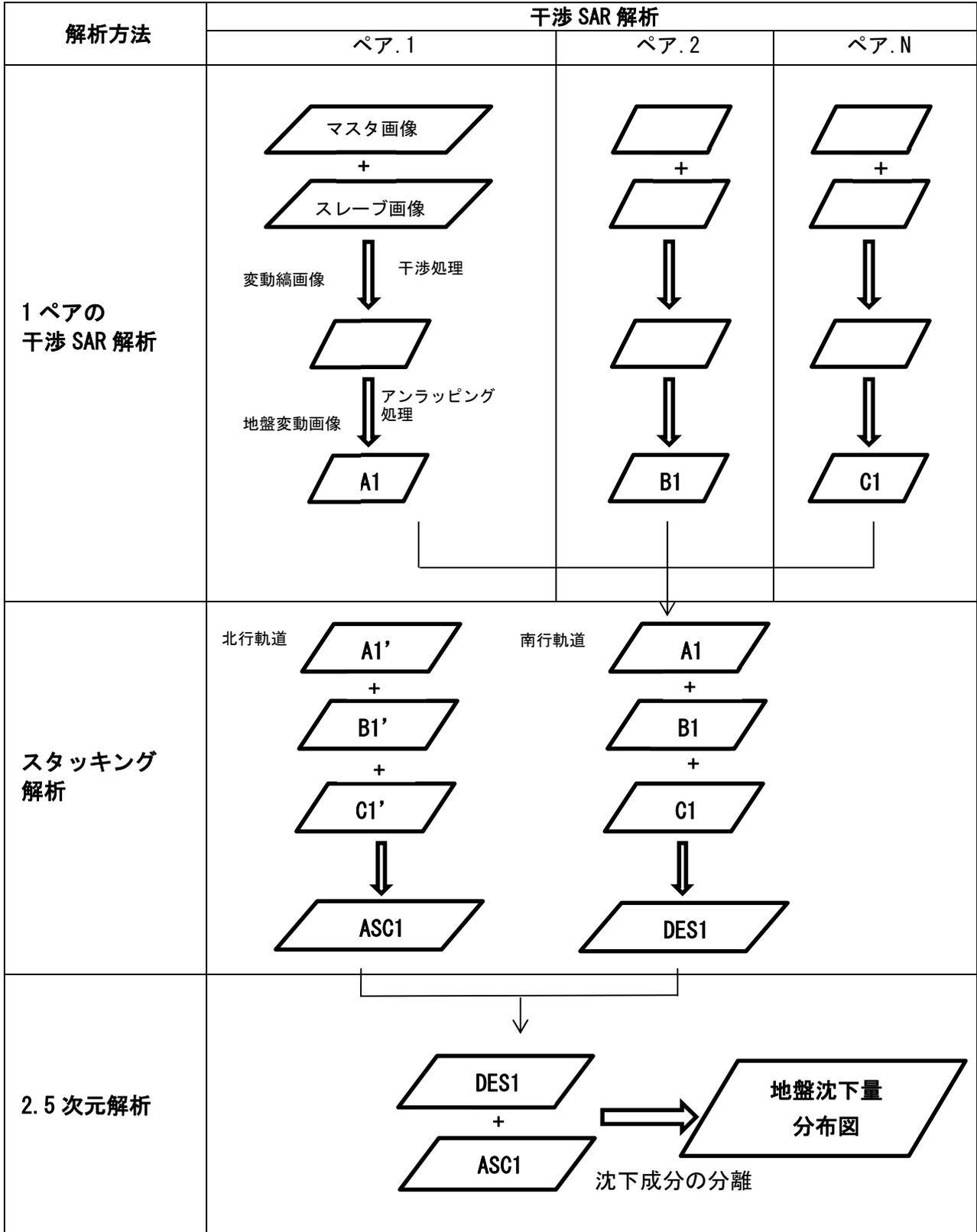
図 2-14 干渉 SAR 解析の全体の流れ
