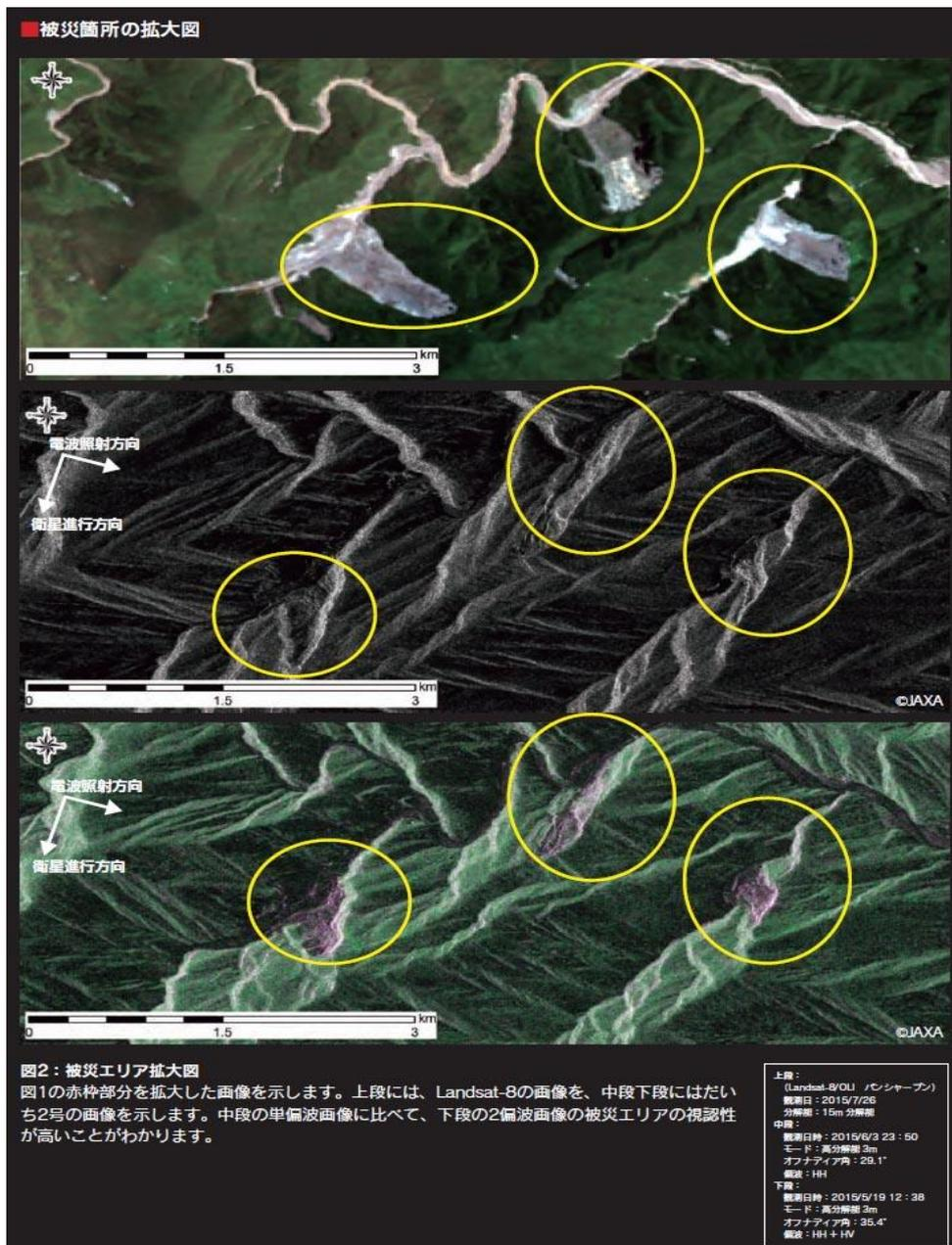
河道閉塞箇所の緊急調査、対策を実施する上では、迅速に発見する手法が必要であり、ヘリ調査のできない夜間・荒天時においても地表状況を観測可能な合成開口レーダー画像を利用できる可能性があります。また、だいち2号の機能向上により高分解能2偏波画像を用いることで、湛水池や河道閉塞箇所の大規模崩落箇所を抽出でき、判読時の視認性が向上することが期待できます。（出典資料を引用）
