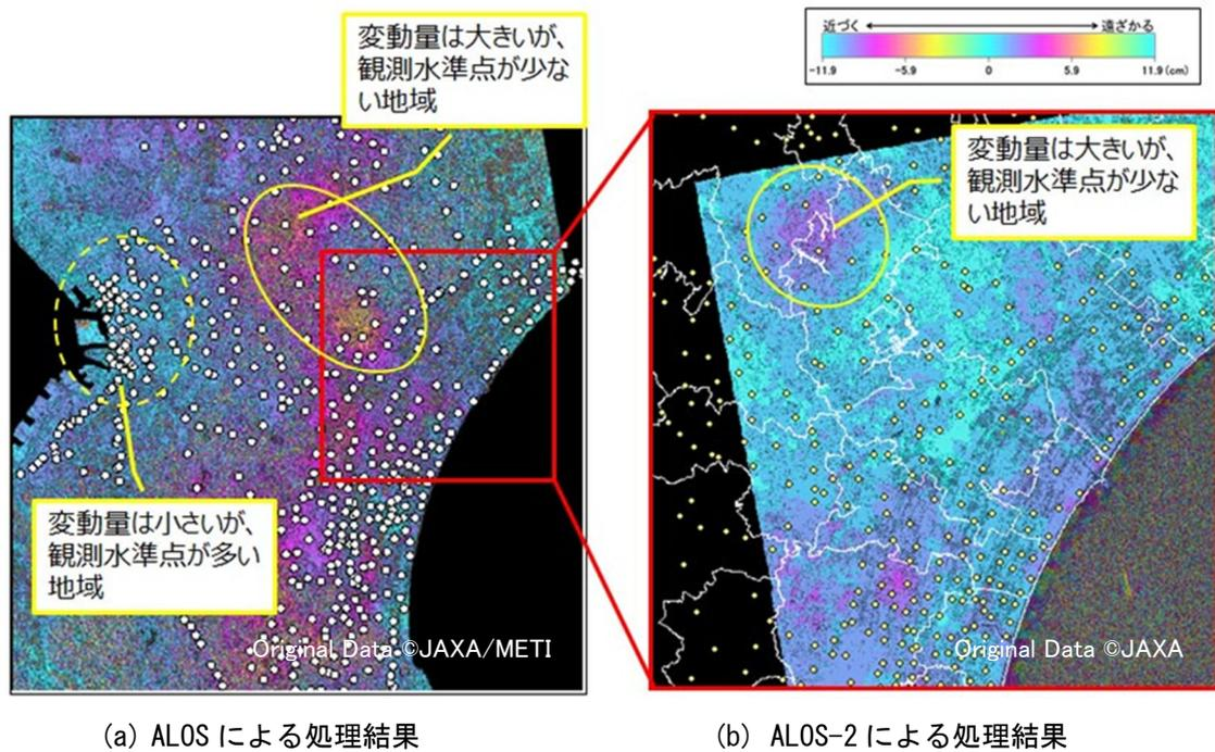
図 3-12 干渉 SAR 解析による変動画像と水準測量観測点の重ね合わせ結果の例
