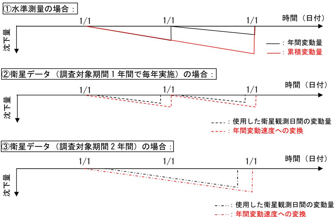
図 2-2 衛星データを用いた地盤高観測における調査期間と変動量把握のイメージ
