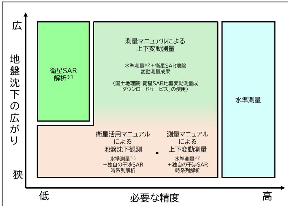
※1:国土地理院「衛星SAR地盤変動測量成果ダウンロードサービス」および衛星活用マニュアルを参考とする「独自の干渉SAR時系列解析」
