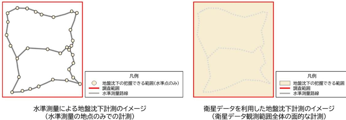
図 1-7 水準測量による地盤沈下計測と衛星データを利用した地盤沈下計測のイメージ
