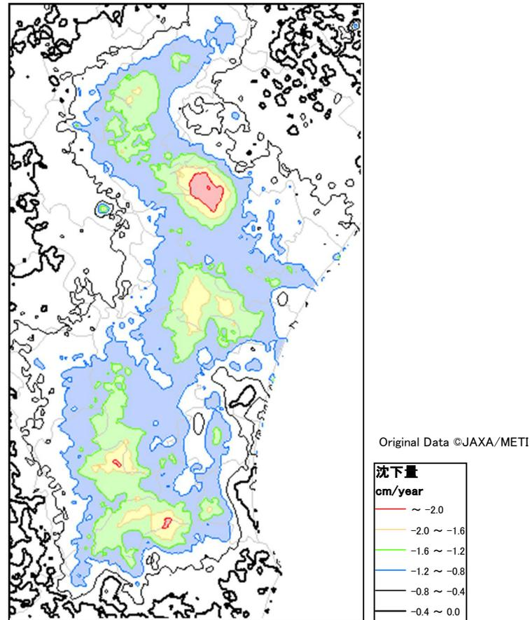
図 2-24 干渉 SAR 解析による地盤沈下量分布図の解析例
