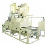
太陽光パネルリサイクル設備
