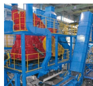
金属破碎・選別設備
