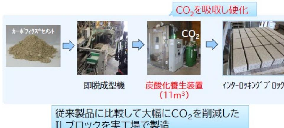
(出典) 太平洋セメント提供資料「CO<sub>2</sub>排吸収・硬化セメント「カーボフィックスセメント」」(2023年)
