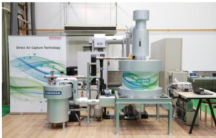
5kg-CO 2 /d規模の試験設備を弊社明石工場内に設置
