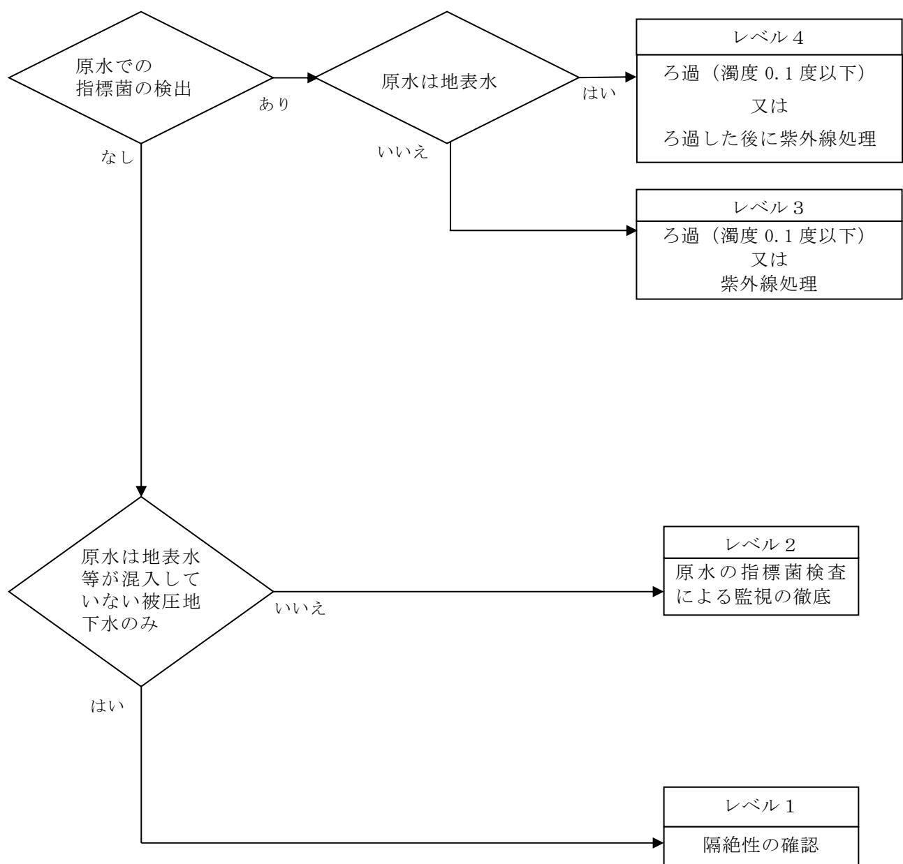
図 水道原水に係るクリプトスパリジウム等による汚染のおそれの判断の流れ
