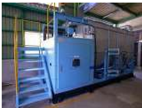
図 5-14 紙おむつ燃料化装置（600kg/日処理）
