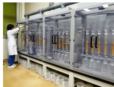
陽イオン交換樹脂によるSrの分離精製 低バックグラウンドベータ線測定装置
