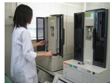
陽イオン交換樹脂によるSrの分離精製 低バックグラウンドベータ線測定装置
