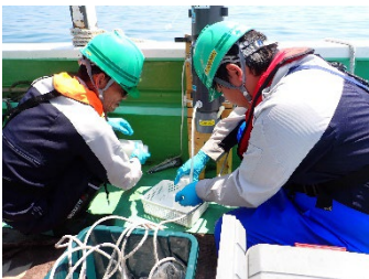
トリチウム分析用海水の採取 (ニスキン採水器から海水の分取)
