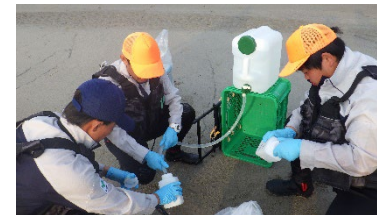
トリチウム分析用海水の採取 (20L容器から海水の分取)
