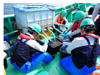
主要7核種分析用海水の採取 (大型容器から海水の分取)
