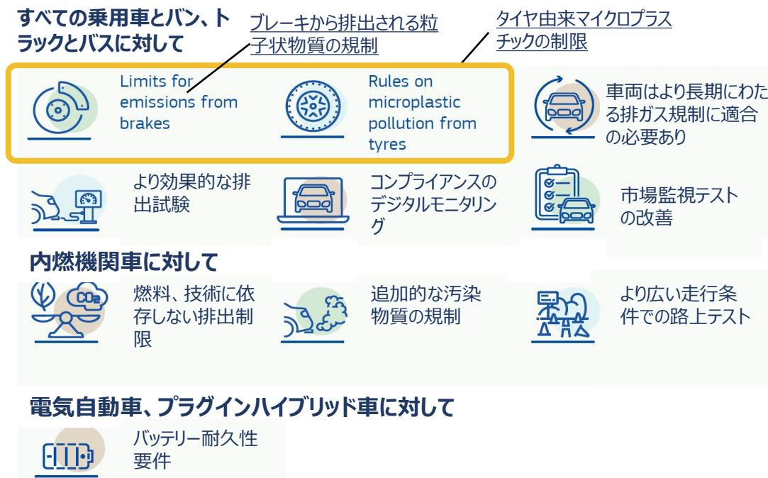
Euro7 では、排気システム以外の発生源（Non-exhaust emissions）、つまり車両に装着された**タイヤやブレーキからの粒子状物質の排出に対する制限**を導入。
