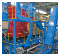
金属破碎・選別設備
