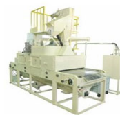
太陽光発電設備リサイクル設備
