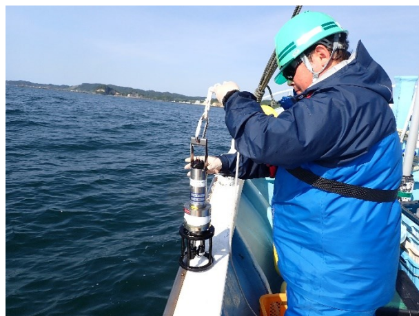
別図 11-9 CTD による水深、水温、塩分の測定 (令和 6 年 5 月 30 日撮影)
