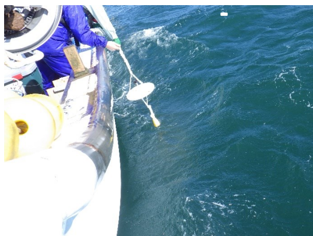
別図 11-11 透明度の測定 (令和 6 年 5 月 21 日撮影)
