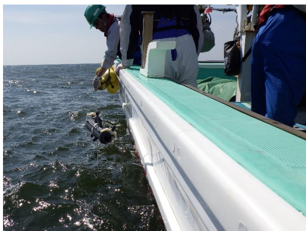
別図 11-13 ニスキン採水器での海水採取 (サンプル採取時近景 令和 6 年 5 月 21 日撮影)
