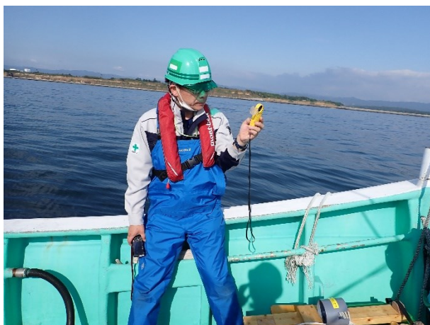
別図 11-8 風向、風速測定 (令和 6 年 5 月 21 日撮影)
