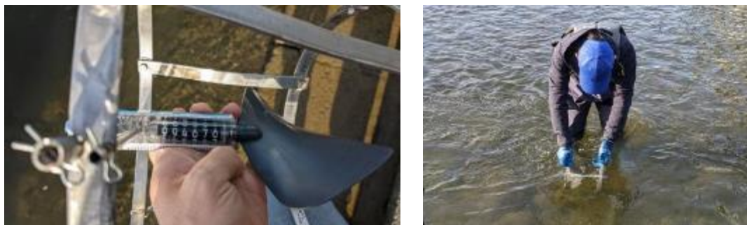
図 3-12 ろ水計を使用した流速の測定
