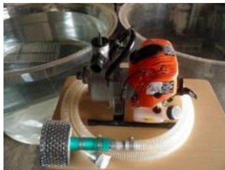
図 4-8 ポンプ及びストレーナの例
