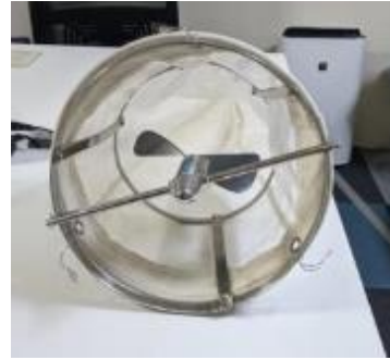
図 3-6 ②金属フレームによる固定の例
