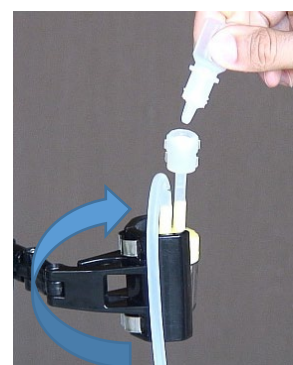
図 53 直径 13 mm フィルターを使用した場合の蛍光染色方法
