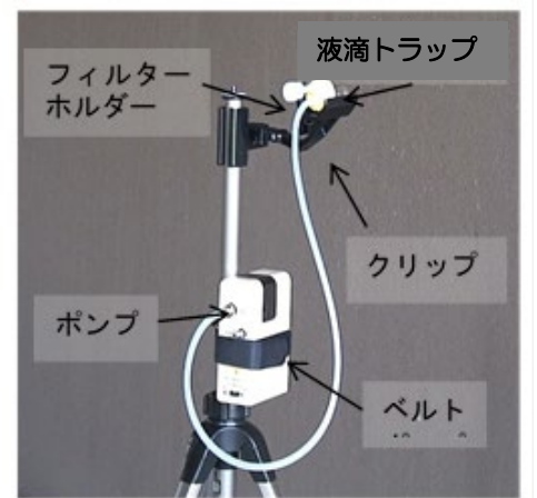
図 52 直径 13 mmオープンフェース型円形フィルターを使用した場合のサンプルリング用捕集器具 一例
