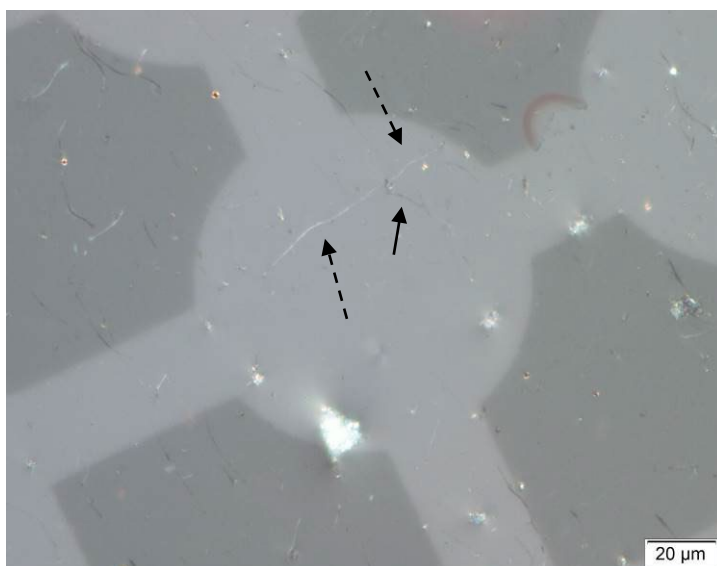
(ii) 直交ニコルでセナルモンコンペンセーターを挿入 セナルモンコンペンセーターのダイヤルを時計回りに回転。
