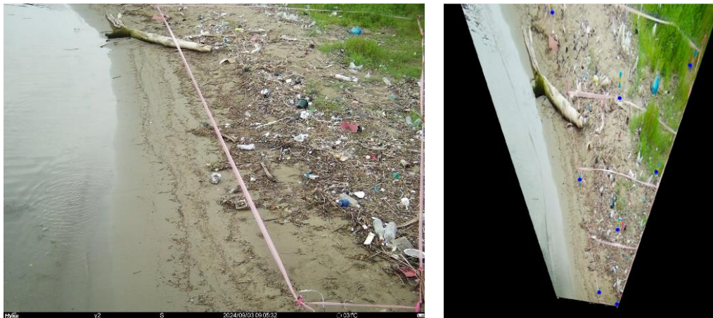
図 5 固定カメラにより海岸を撮影した画像（左）と射影変換した画像（右）
