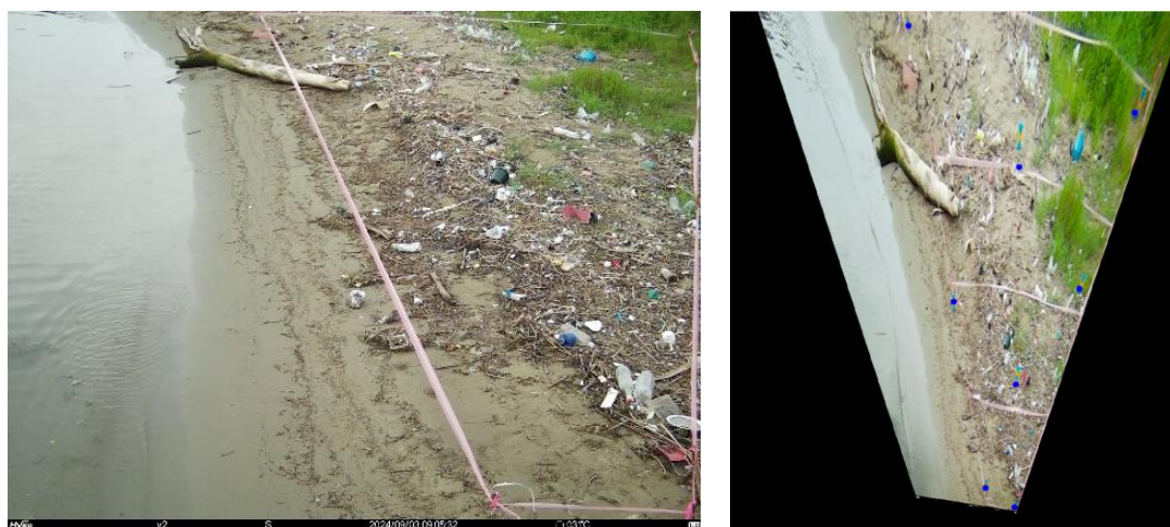
図 2.1.4 固定カメラにより海岸を撮影した画像 (左) と射影変換した画像 (右)
