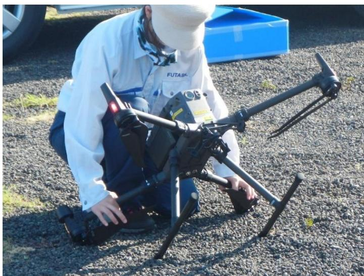
図 1.1.8 IMU の校正
