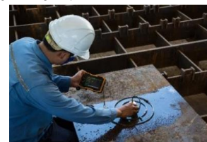
左図：液体接触媒質を使用した従来の超音波検査（上記①） 右図：風力発電における昆虫の衝突・付着の状況（上記②）
