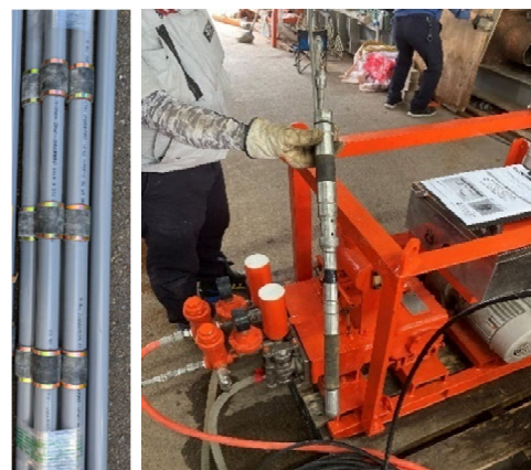
図 2 スリーブバルブが 33.3cm 間隔で取り付けられているダブルパッカー注入外管 (左) と注入内管 (右)
