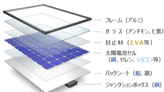
太陽電池モジュールの構造（有害・資源性物質）
