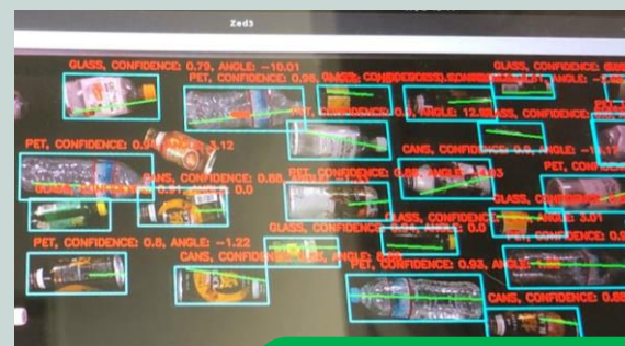
飲料容器の画像認識とロボット選別
