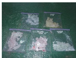
図 2-2-3 製作した低濃度臭素含有プラスチックの外観 (濃度区分ごとに塗色している)
