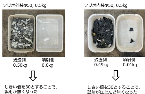
図 2-2-10 管電圧=115kV, 管電流=2.5mA, しきい値=30 におけるブランクテストの結果
