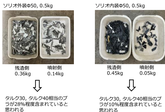
図 2-2-9 管電圧=115kV, 管電流=2.5mA, しきい値=15 におけるブランクテストの結果
