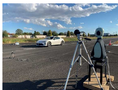
通過騒音測定イメージ (ダミーヘッドを用いた測定)
