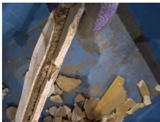
図 6.21 図 6.20 と石膏ボードの接着 (B 邸建設系混合廃棄物)
