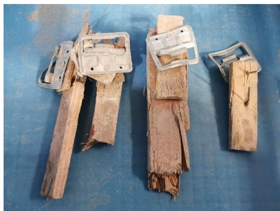
図 6.16 木くずと金属くずの接着（A 邸建設系混合廃棄物）
