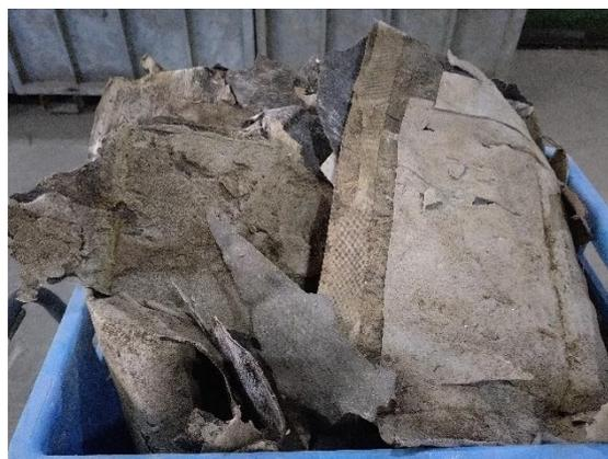
図 6.6 ルーフィング（A 邸建設系混合廃棄物）
