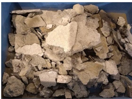
図 6.18 がれき（B 邸建設系混合廃棄物）
