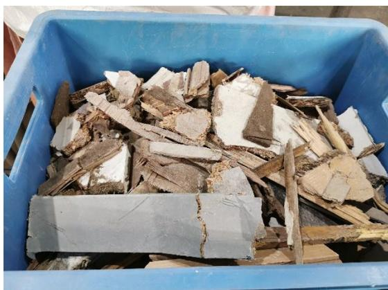
図 6.7 木チップとプラスチックシートの接着（A 邸建設系混合廃棄物）
