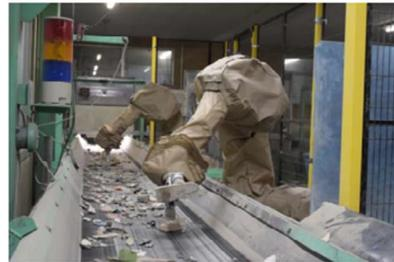
ベルトコンベアを流れる建設混合廃棄物から設定した品目のみ自動選別
