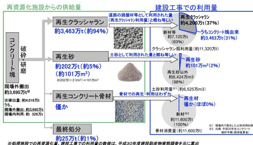
図 3.2.1 コンクリート塊のリサイクル、処理・処分の状況<sup>80</sup>
