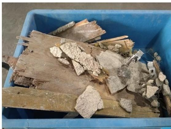
図 6.12 がれき、木くず、金属くずの接着（A 邸建設系混合廃棄物）
