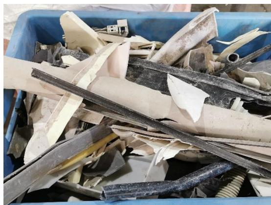
図 6.4 硬質プラスチック（A 邸建設系混合廃棄物）
