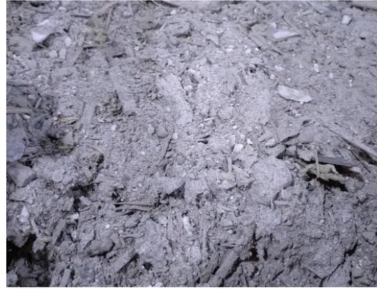
図 6.2 残渣（A邸建設系混合廃棄物）
