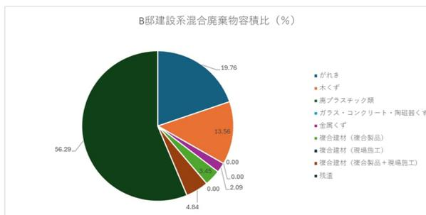
図6.28 B邸の建設系混合廃棄物の容積比のグラフ
