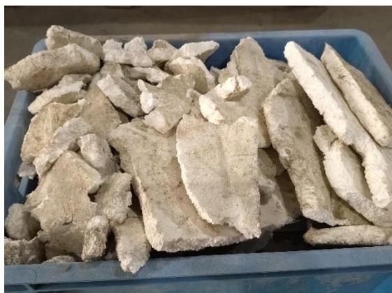
図 6.3 断熱材（A 邸建設系混合廃棄物）
