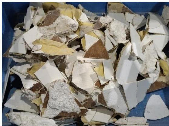
図 6.10 石膏ボードとセラミックの接着（A 邸建設系混合廃棄物）
