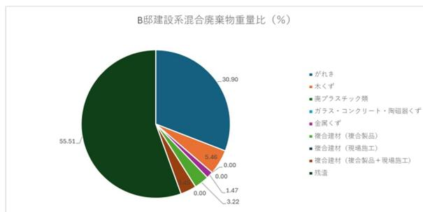
図6.27 B邸の建設系混合廃棄物の重量比のグラフ
