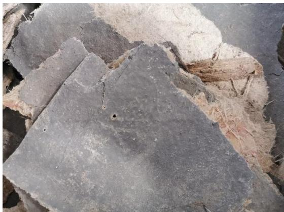
図 6.13 繊維強化素材（A 邸建設系混合廃棄物）
