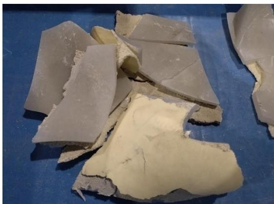
図 6.11 プラスチックとセラミックの接着（A 邸建設系混合廃棄物）
