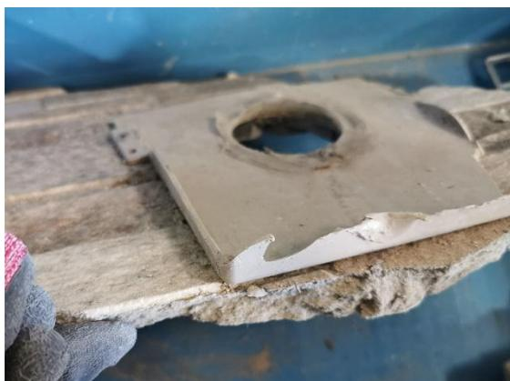
図 6.15 がれきとプラスチックの接着（A 邸建設系混合廃棄物）
