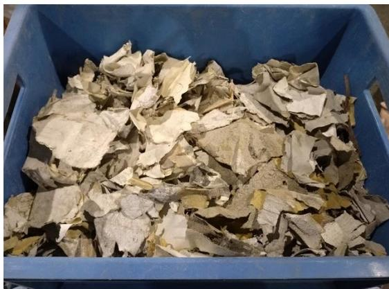
図 6.9 石膏ボードと壁紙の接着（A 邸建設系混合廃棄物）
