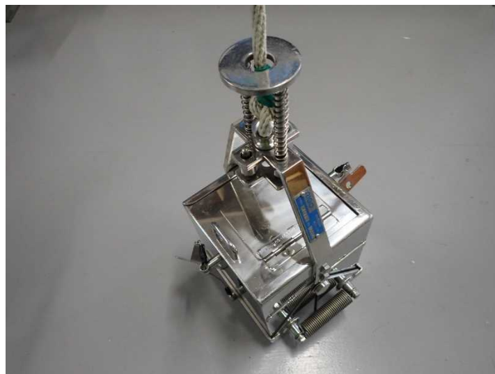
図. 2 エクマンバージ型採泥器
