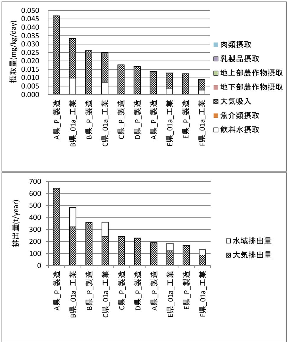
図 5-4 化審法届出情報に基づく仮想的な排出源毎の推計排出量に対する推定摂取量
