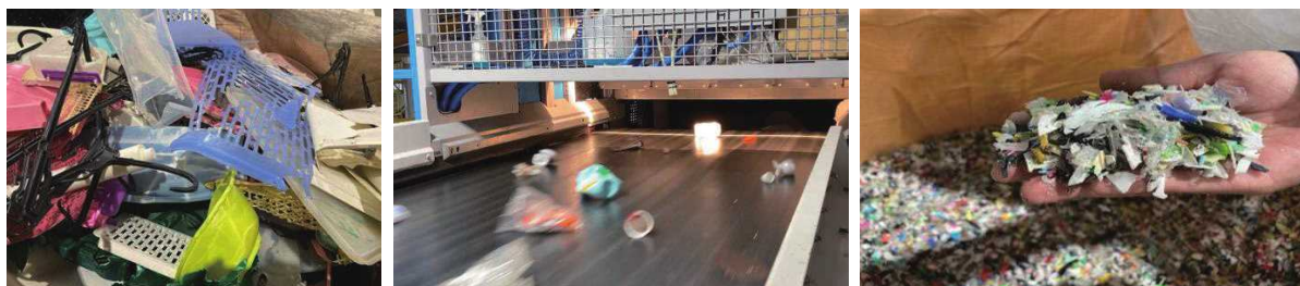
図 5.1-1 施設の写真（左から、一括回収プラから選別された製品プラ、近赤外線選別での照射・選別の様子、製品プラの粉碎品）
