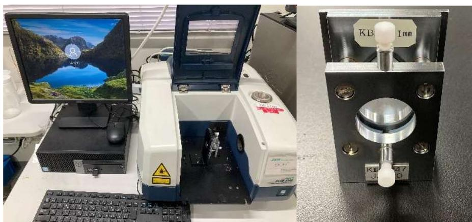
図 3.2.4 FTIR 分光装置（日本分光製 FT/IR-430）
