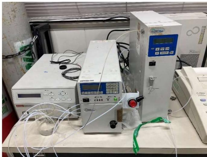
図 3.2.3 イオンクロマトグラフ装置（ノンサプレッサー方式）
