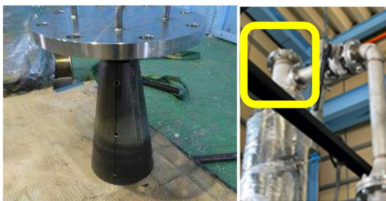
図 4.2 テレフタル酸除去専用パーツ、及び反応塔上部の取付箇所
