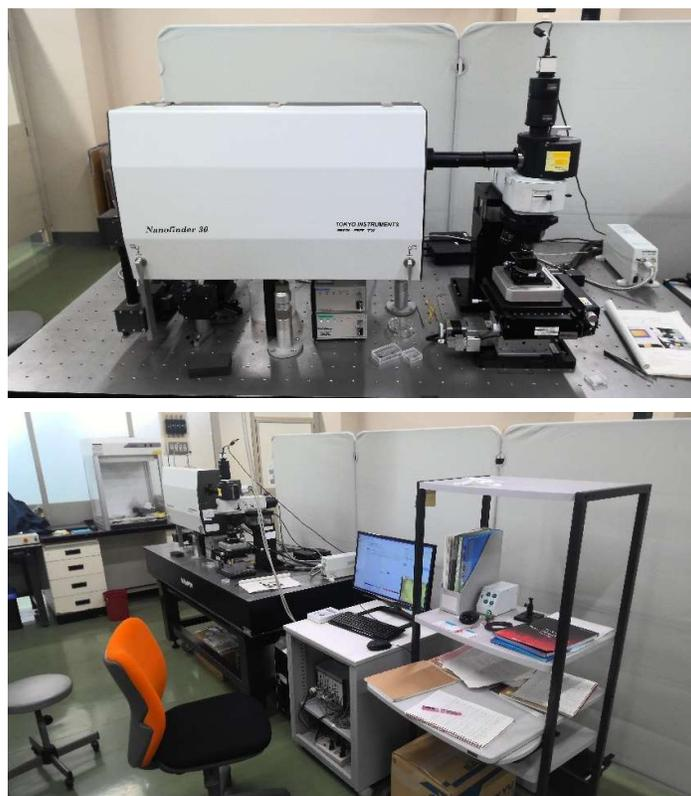
図 3.2.5 レーザーラマン分光装置 (Nanofinder30)
