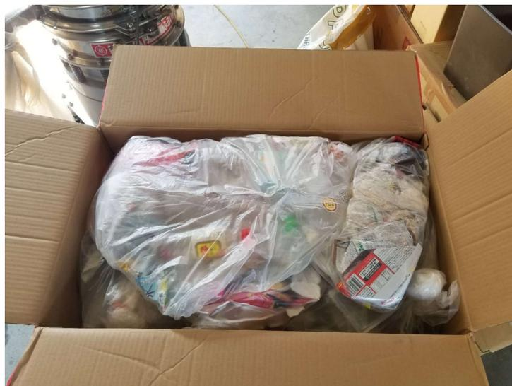
図 2.2.3 エコポート九州にて光学選別を行った後の試料
