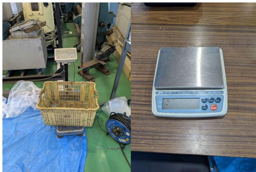
図 2.5 試料の重量測定装置
