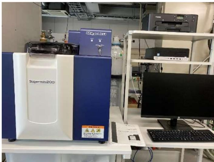
図 3.2.1 株式会社リガク 波長分散小型蛍光 X 線分析装置 (Supermini200)
