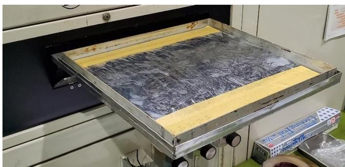
図 3-3-10 rCF の配置状況 (EB 処理)
