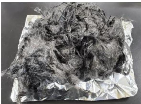
図 3-1-13 200L スケールアップ試作回収 rCF
