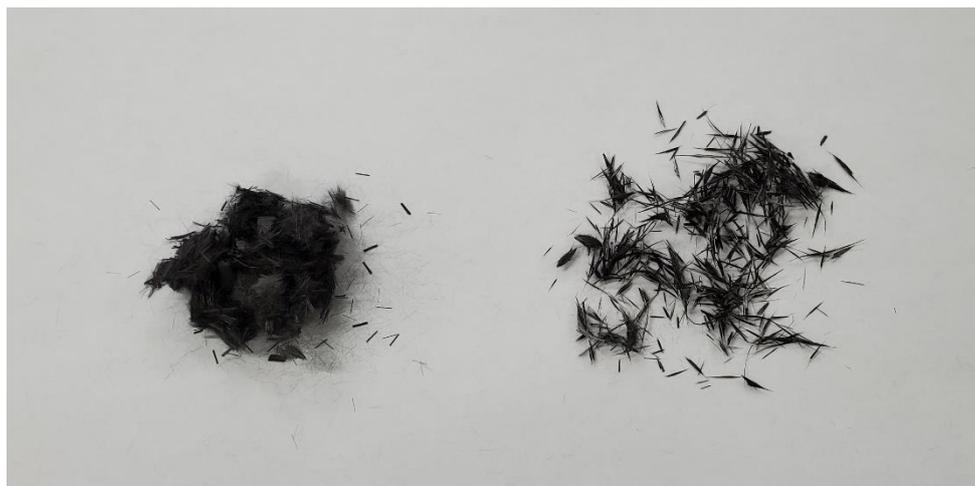
図 3-3-14 サイジング処理前後の繊維外観 (左:処理前、右:処理後)
