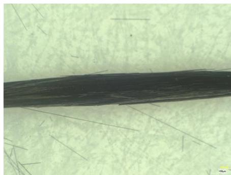
図 3-3-16 サイジング処理後のマイクロスコープ像
