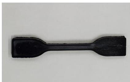
図 3-4-2 ダンベル試験片(引張試験用)
