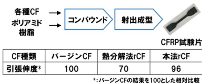
図 2-2-2 本技術で得られた rCF を用いたコンパウンド品の評価
