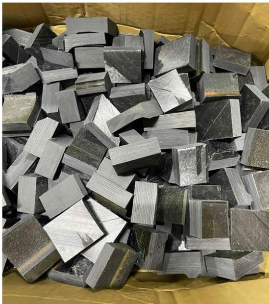
図 3-1-7 CFRP(細断後)の形態
