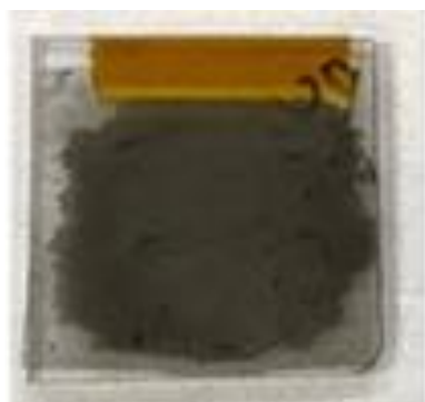
図 18 バイオ TPU フィルム単体の防汚試験後の外観（ランク 1）
