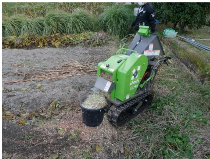
図 68 チッパー。甘性ソルガム搾汁後の稈を粉碎して 牛飼料とするため、チッパー車を導入した
