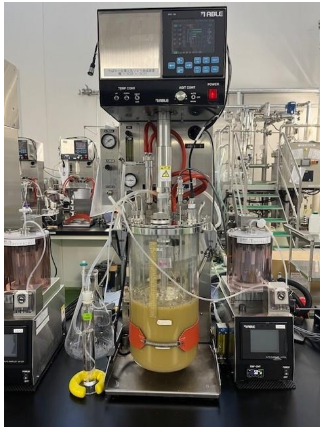
図 72 全容 10L 培養装置を用いたエタノール発酵試験の様子
