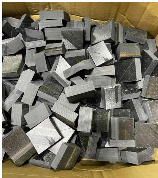
図 3-1-7 CFRP(細断後)の形態
